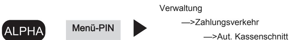
Mit der Funktion automatischer Kassenschnitt können Sie im Terminal einstellen, wann das Terminal einen Kassenschnitt durchführen soll. Hierbei können Sie die Anwahlzeit und die Wochentage bestimmen zu der der automatische Kassenschnitt erfolgen soll.
