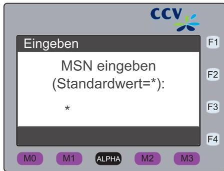
Sollten Sie eine bestimmte MSN für den Betrieb am ISDN Netz benötigen, so können Sie diese hier eingeben.
